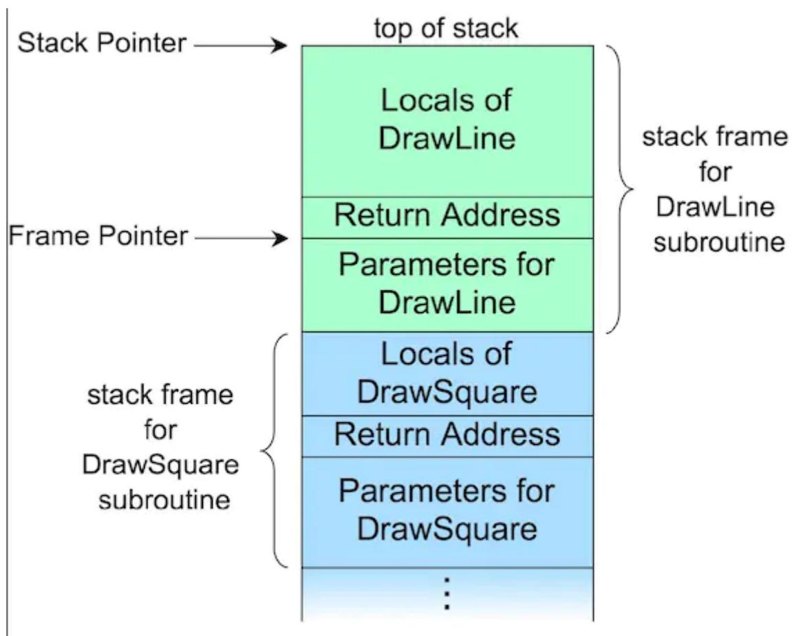
调用栈最经常被用于存放子程序的**返回地址**。在调用任何子程序时，主程序都必须暂存子程序运行完毕后应该返回到的地址。因此，如果被调用的子程序还要调用其他的子程序，其自身的返回地址就必须存入调用栈，在其自身运行完毕后再行取回。除了返回地址，还会保存 **本地变量**、**函数参数**、**环境传递** (Scope?)
